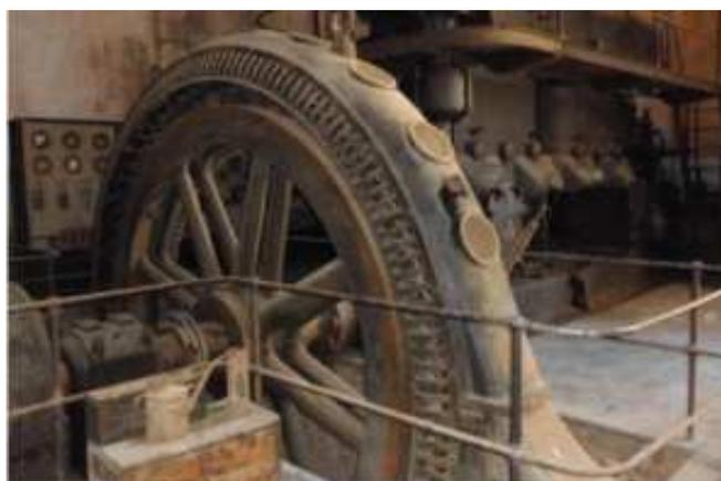
Fig. 57 - Gerador de energia eléctrica Krupp-Bosch (Foto do autor)
