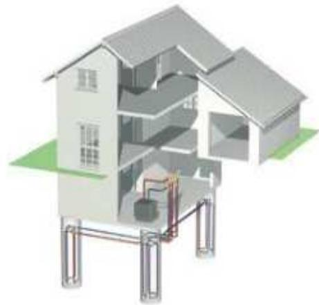
Fig. 74 - Captação vertical - sondas sob estrutura do edifício
