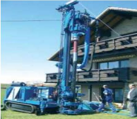
Fig. 75 - Máquina perfuradora para introdução das sondas térmicas no solo.
