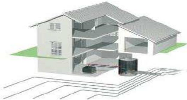
Fig. 71 - Circuito de sondas de aproveitamento horizontal.
