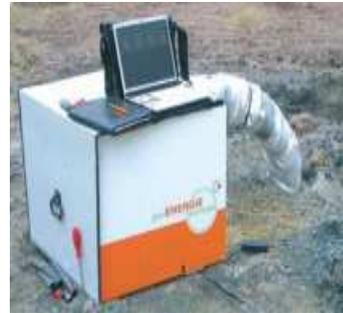
Fig. 76 - Aparelho para medição da inércia do solo.
