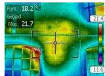
Fig. 136 - Imagem termográfica mostrando deficiente isolamento da fachada.
